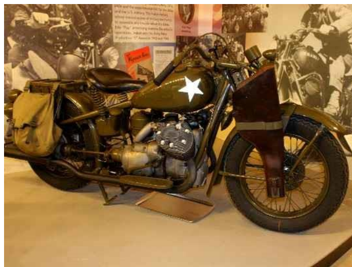
La Harley Davidson XA bicilindrica di 750 cc usata nella Seconda Guerra Mondiale
